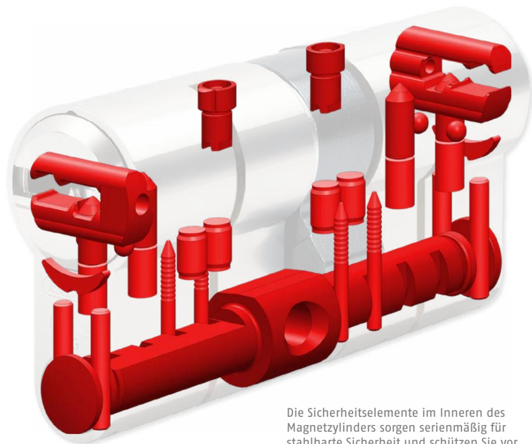
Die Sicherheitselemente im Inneren des Magnetzylinders sorgen serienmäßig für stahlharte Sicherheit und schützen Sie vor Zylindermanipulation: Der Edelstahl-Steg ist das Herzstück des Systems und sorgt für einen erhöhten Zieh- und Bruchschutz. Das Bohrschutz-Inlay aus hochfestem Edelstahl und die gehärteten Stahlelemente im Zylindergehäuse und Zylinderkern bieten zusätzlich einen erhöhten Bohrschutz.
