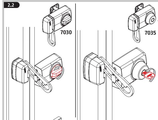
**i** (DE) Sperrbügelfunktion: Tür kann spaltbreit geöffnet werden. Zum Öffnen der Tür: Sperrbügel anheben, Tür schließen, Riegel ganz zurückschließen.
