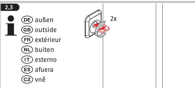
**i** (DE) Beim Schlosstyp 7010 / 7030 muss der Drehknopf nach jeder Betätigung wieder waagerecht stehen!
