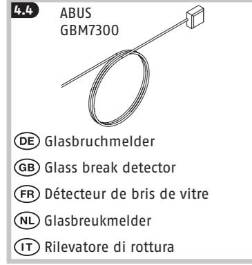
(DE) Optional kann ein Glasbruchmelder ABUS GBM7300 B (braun) / W (weiß) per Draht an die Schraubklemme der Elektronikeinheit angeschlossen werden. Dazu Drahtbrücke losschrauben >> 4.2 d, entfernen und durch die beiden Kabelenden des GBM ersetzen. FG300A löst dann auch bei Detektion von Glasbruch Alarm aus. Zur Kabeldurchführung öffnen Sie das Gehäuse an der Unterseite an der vorperforierten Stelle. Installation: >> ABUS GBM7300.
