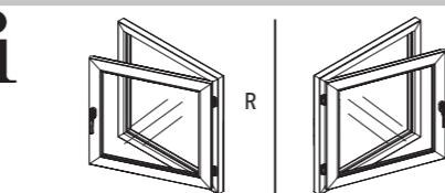
(DE) Anleitung zeigt die Montage an einem Fenster DIN rechts (R). Bei DIN linken Fenstern erfolgt die Montage seitenverkehrt
