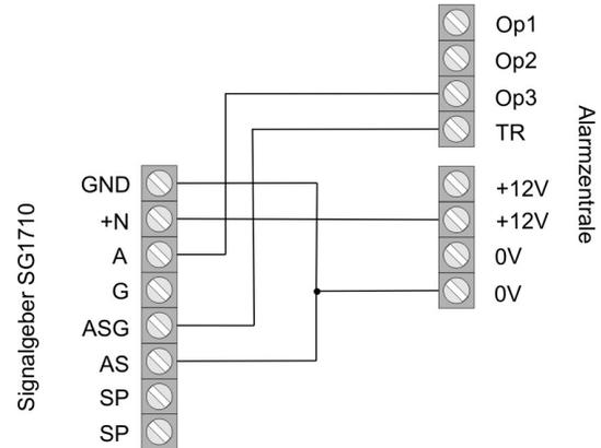
Bei Verwendung der Sirene muss der Transistorausgang 1 (Programmierenü: Menüpunkt 081) auf Sirene (00) gesetzt sein.
