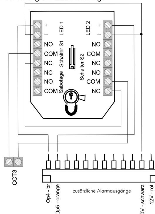
Bitte lesen Sie hierzu auch die Bedienungsanleitung des Schlüsselschalters durch. Bitte beachten Sie, dass das Schaltverhalten des Schlüsselschalters auf Impuls eingestellt ist. Die oben gezeigte Schaltung ermöglicht es Ihnen die Alarmanlage durch Drehen des Schlüssels in beide Richtungen zu aktivieren bzw. zu deaktivieren. Auch hier wird die Sabotageleinie noch nicht an die Zentrale angeschlossen. Die Einstellungen der Transistor- und zusätzlichen Schaltausgänge zeigen wir später.
