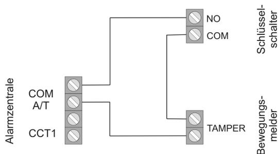
Wenn Sie ausschließlich Melder ohne Sabotagekontakt verwenden, müssen Sie eine Brücke zwischen COM und A/T an dem Alarmsystem einfügen
