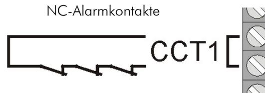
Ein Anschluss von Schließerkontakten (NO-Melder, normally open) ist an der Terxon S nicht möglich.
