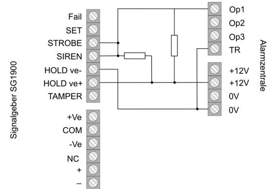
Verwenden Sie zum Anschluss der SG1900 die beigefügten Widerstände (1k Ohm). Vergessen Sie nicht den Anschluss des internen Akkus von NC auf Battery (-) umzuklemmen.
