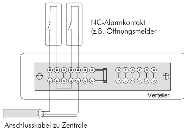
Wie bereits angesprochen, wertet die Alarmzentrale die Alarmzonen über den vorhandenen Stromfluss aus. Die meisten in der Alarmtechnik verwendeten Melder sind Öffnerkontakte, d.h. die Melder unterbrechen bei Alarm den Stromfluss auf der Alarmzone. Die Melder werden als Öffner, oder auch als NC-Melder (normally closed) bezeichnet, und werden wie folgt angeschlossen (**Die Brücke zwischen CCT, wenn vorhanden, ist zu entfernen**):
