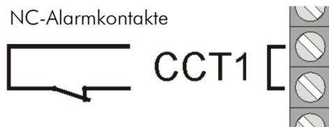
Zum Teil ist es notwendig, mehrere Alarmkontakte in einer Zone zusammenzuschließen. Schalten Sie hierfür die Öffnerkontakte in einer Reihenschaltung.
