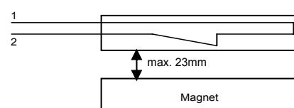
**Indbygningsmontering:** For indbygning af kontakt, omskifter og magnet. Hul størrelse (8,0 + 0,2) mm skal børes. Omskifteren skal glide let på plads sådan at den ikke kan fjernes uden værkøj. Den må ikke opsættes på ferrimagnetiske materialer.
