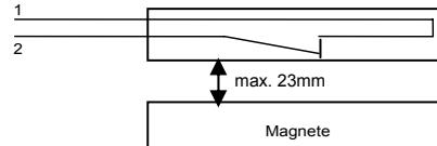
**Montaggio integrato:** Per il montaggio integrato dei contatti occorre trapanare fori di grandezza 8,0 + 0,2 mm, sia per l'interruttore che per il magnete. L'interruttore deve poter essere introdotto con facilità senza perciò poter essere estratto dalla sede a meno di utilizzare un attrezzo ausiliare. Per evitare danni occorre stabilire i contatti senza usare eccessiva forza.
