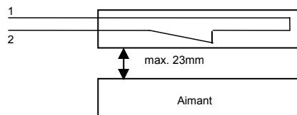
**Encastrement:** Le perçage de trous de (8,0 + 0,2) mm est nécessaire tant pour l'encastrement de l'interrupteur que pour celui de l'aimant. L'introduction de l'interrupteur dans le trou doit être aisée. Cependant il doit y être coincé, de sorte qu'il ne puisse pas en être retiré sans autre moyen technique. Ne pas encastrer le contact par la force pour éviter tout endommagement. L'encastrement de contacts dans des matériaux ferromagnétiques ou à noyau ferromagnétique n'est pas autorisé.
