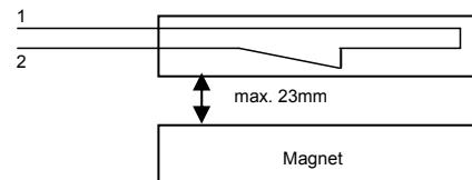
**Aufbaumontage:** Der Reedschalter bzw. der Magnet wird in das Aufbaugehäuse eingesetzt. Für die Zuleitung wird aus dem Gehäuseoberteil an der vorgesehenen Stelle die Aussparung ausgebrochen. Die Befestigungsschrauben werden mit den beigefügten Abdeckkappen bzw. mit den Gehäuseoberseiten abgedeckt. Bei der Montage auf magnetisch leitendem Untergrund sind antimagnetische Schrauben, sowie das Zubehör (Distanzblock) zu verwenden.
