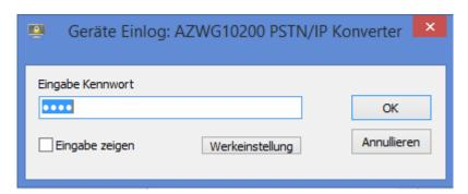
Falls das Kennwort nicht bekannt ist, kann das Gerät über die Taste "Werkseinstellung" zurückgesetzt werden. !ACHTUNG, alle Programmierdaten werden hierbei gelöscht!
