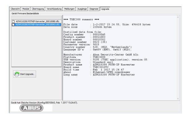
Wählen Sie in der linken Seite das gewünschte Upgrade. Rechts wird die detaillierte Information des Upgrades angezeigt. Wenn das Upgrade mit der Variante des AZWG10200-PSTN/IP-KONVERTERS übereinstimmt, wird die "Start Upgrade"-Taste aktiv. Klicken Sie auf "Start Upgrade" und folgen Sie dem Ablauf auf dem Bildschirm.
