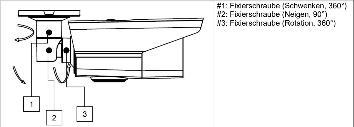
Nach Ausrichtung der Kamera erfolgt die Zoom- und Fokuseinstellung über die Steuerung über den Analog HD Digitalrekorder.
