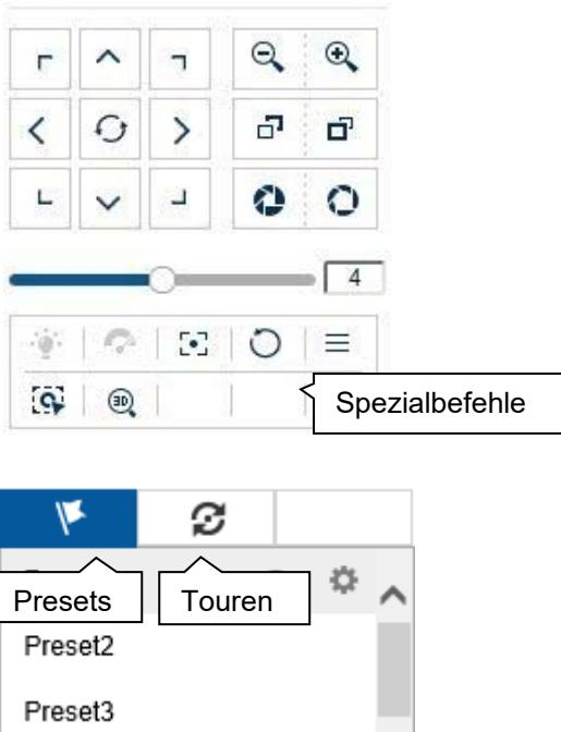
Die Aktionen aller Schaltflächen im PTZ-Steuermenü, sowie Presets/Touren werden immer auf die aktuell ausgewählte Kamera (rote Markierung) angewendet. Abhängig vom Kameramodell stehen möglicherweise nicht alle Funktionen zur Verfügung.
