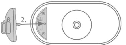
Setzen Sie die neue rote Abdeckung ein, die im Lieferumfang des Solarpanels enthalten ist, sodass die neue Abdeckung komplett eben zur Rückseite der WLAN Akku Cam sitzt und die Wasserdichtigkeit gewährleistet ist.
