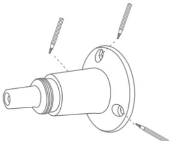
Markeer de positie van de vereiste 3 boorgaten op de gewenste plek met behulp van de boormal of de wandhouder en bijv. een potlood. Hiervoor kunt u de houder uit elkaar schroeven. Houd bij het kiezen van de locatie ook rekening met de maximale kabellengte van het zonnepaneel.
