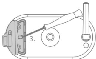
**Suggerimento:** per posizionare il piccolo ancoraggio in gomma all'interno della nuova copertura, è possibile utilizzare un oggetto stretto, ad esempio un cacciavite molto piccolo. Assicurarsi che l'ancoraggio tenga saldamente la nuova copertura rossa.
