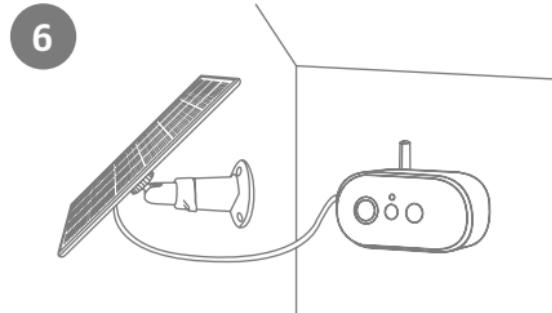
Tilslut USB-C-stikket på solpanelkablet til USB-C-porten på batterikameraet Pro. Sørg for, at stikket sidder korrekt og fast. Sørg også for, at gummitætningerne sidder korrekt for at sikre vandtæthed.
