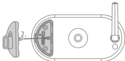
Installe le nouveau couvercle rouge fourni avec le panneau solaire, de sorte qu'il soit complètement à plat par rapport à l'arrière de la caméra sans fil Pro et que l'étanchéité soit garantie.
