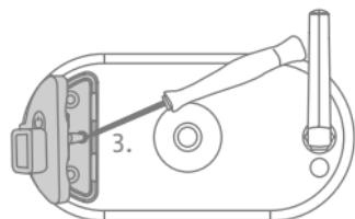
**Tip:** For at placere det lille gummianker på indersiden af den nye afdækning kan du bruge en smal genstand, f.eks. en meget lille skruetrækker. Sørg for, at ankeret holder den nye afdækning sikkert fast.
