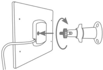
Ruotare il giunto sferico del supporto con la filettatura nell'apertura corrispondente sul lato posteriore del pannello solare. Stringere il dado di raccordo in dotazione in modo che il giunto sferico e il pannello solare siano collegati in modo stabile.
