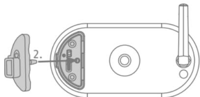
Inserire la nuova copertura rossa fornita con il pannello solare in modo che sia completamente a livello con il lato posteriore della telecamera a batteria Pro e garantisca l'impermeabilità.
