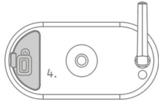
Setze die neue rote Abdeckung ein, die im Lieferumfang des Solarpanels enthalten ist, sodass die neue Abdeckung komplett eben zur Rückseite der Akku-Kamera Pro sitzt und die Wasserdichtigkeit gewährleistet ist.
