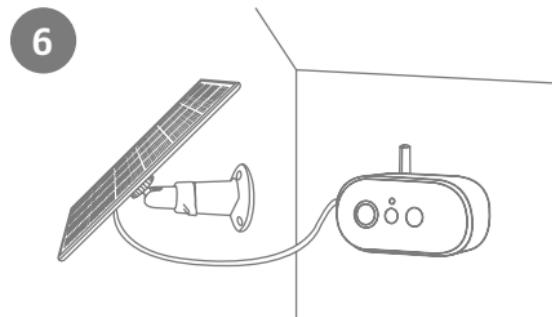
När du har monterat alla komponenter ska du återigen kontrollera att det nya locket på kamerans baksida och USB-C-kontakten sitter ordentligt så att anslutningen är vattentät. Beroende på monteringssituationen på plats: För att avlasta kabeln kan du fästa den mellan solpanelen och kameran med hjälp av kabelklämmorna.
