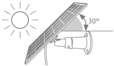
Finjuster solpanelet, så det modtager så meget sollys som muligt i løbet af dagen. Vi anbefaler at vippe solpanelet i en vinkel på ca.  $30^{\circ}$  i forhold til en imaginær vandret linje. Spænd nu kugleleddet med vingeskruen.
