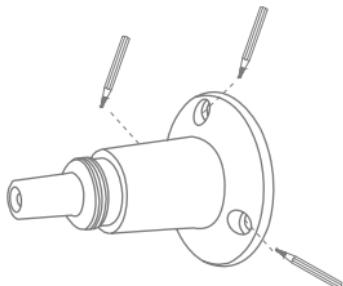
Marca la posición de los 3 orificios necesarios en el lugar deseado utilizando la plantilla de perforación o el soporte mural y, por ejemplo, un lápiz. Puedes desenroscar el soporte para ello. Al elegir la ubicación, ten en cuenta también la longitud máxima del cable del panel solar.
