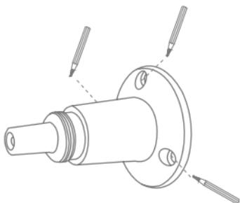
Markiere am gewünschten Einsatzort mithilfe der Bohrschablone oder der Wandhalterung und z. B. einem Stift die Position der benötigten 3 Bohrlöcher. Hierfür kannst du die Halterung auseinanderschrauben. Beachte bei der Wahl des Standorts auch die max. Kabellänge des Solarpanels.
