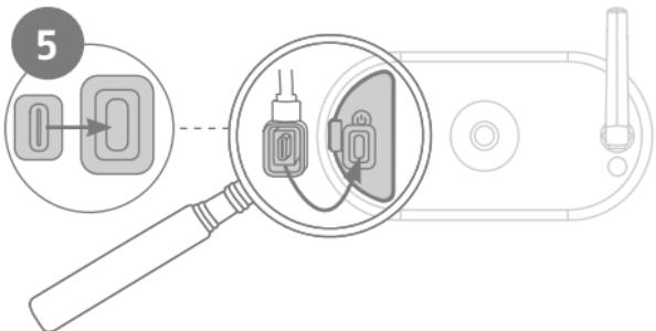
Anslut solpanelkabelns USB-C-kontakt till USB-C-porten på den batteridrivna kameran Pro. Kontrollera att kontakten sitter stadigt och korrekt. Kontrollera också att gummitätningarna sitter rätt för att säkerställa vattentätheten.
