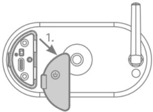
Entferne auf der Rückseite deiner Akku-Kamera Pro die originale rote Abdeckung vollständig, indem du die Gummi-Verankerung der roten Abdeckung komplett herausziebst.
