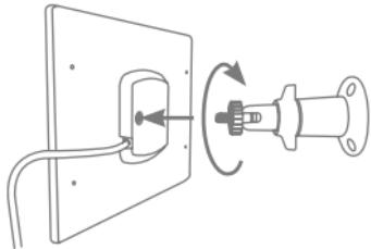
Drehe das Kugelgelenk der Halterung mit dem Gewinde in die entsprechende Öffnung auf der Rückseite des Solarpanels. Ziehe die beiliegende Überwurfmutter an, sodass Kugelgelenk und Solarpanel stabil verbunden sind.
