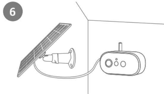
Connecte la fiche USB-C du câble du panneau solaire au port USB-C de la caméra sans fil Pro. Veille à ce que la fiche soit correctement et solidement fixée. Veille également à ce que les joints en caoutchouc soient correctement positionnés afin de garantir l'étanchéité à l'eau.
