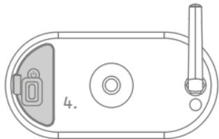
Plaats de nieuwe rode afdekking die met het zonnepaneel wordt meegeleverd, zodat de nieuwe afdekking volledig gelijk ligt met de achterkant van de Accu-Camera Pro en voor waterdichtheid zorgt.
