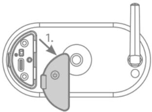
På bagsiden af dit batterikamera Pro skal du fjerne den originale røde afdækning helt ved at trække gummiankret på den røde afdækning helt ud.
