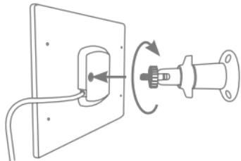
Draai het kogelgewicht van de houder met de Schroefdraad in de overeenkomstige opening aan de achterkant van het zonnepaneel. Draai de meegeleverde wartelmoer vast, zodat het kogelgewicht en het zonnepaneel stevig verbonden zijn.
