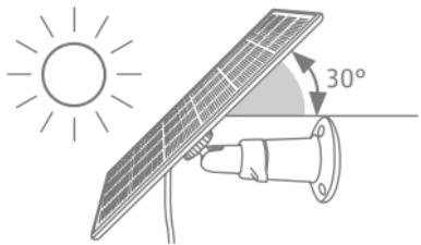
Finjustera solpanelen så att den får så mycket solljus som möjligt under hela dagen. Vi rekommenderar att solpanelen lutas i en vinkel på ca  $30^\circ$  mot en tänkt horisontell linje. Dra nu åt kulleden med vingskruven.
