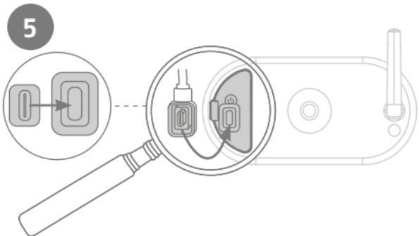
Collegare la spina USB-C del cavo del pannello solare alla porta USB-C della telecamera a batteria Pro. Assicurarsi che la spina sia correttamente e saldamente inserita. Assicurarsi inoltre che le guarnizioni in gomma siano posizionate correttamente per garantire l'impermeabilità.
