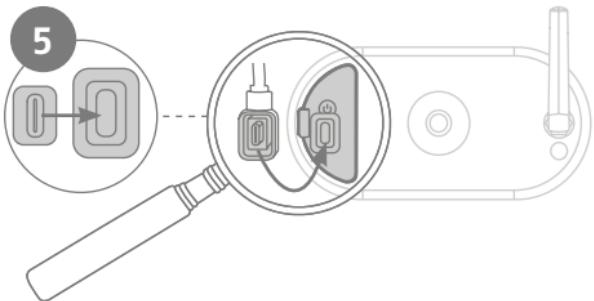
Podłącz wtyczkę USB-C kabla panelu słonecznego do portu USB-C kamery akumulatorowej Pro. Upewnij się, czy wtyczka jest osadzona prawidłowo i mocno. Upewnij się również, czy gumowe uszczelki są osadzone prawidłowo, aby zapewnić wodoszczelność.
