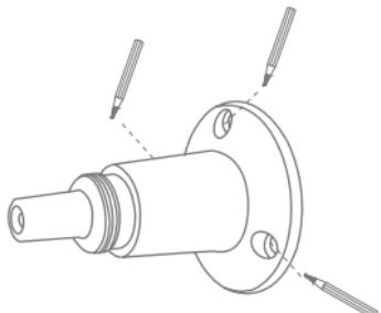
Marker placeringen af de 3 nødvendige borehuller på det ønskede sted ved hjælp af boreskabelonen eller vægbeslaget og f.eks. en blyant. For at gøre dette kan du skru holderen fra hinanden. Når du vælger placering, skal du også overveje solpanelets maksimale kabellængde.
