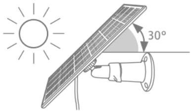
Feinjustiere das Solarpanel so, dass es über den ganzen Tag hinweg möglichst viel Sonnenlicht erhält. Wir empfehlen das Solarpanel in einem Winkel von ca. 30° gegenüber einer gedachten horizontalen Linie zu neigen. Schraube nun das Kugelgelenk mithilfe der Flügelschraube fest.
