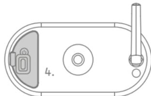
**Viktigt:** För att garantera den nödvändiga vattentätheten måste det nya locket sitta plant och centralt utan att buckla ut.
