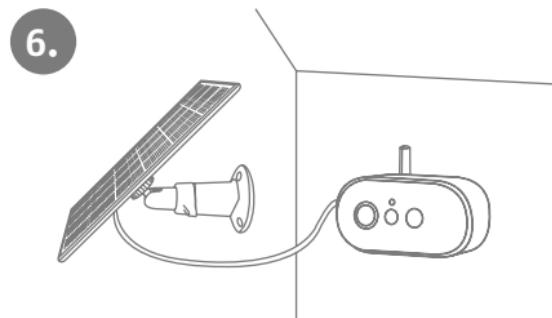
Nadat afronding van de montage van alle onderdelen, controleert u nogmaals of het nieuwe klepje aan de achterkant van de camera en de USB-C connector goed zitten, zodat deze verbinding waterdicht zijn. Afhankelijk van de montagesituatie ter plaatse: Voor trekontlasting of naar eigen inzicht kunt u de kabel tussen het zonnepaneel en de camera vastzetten met de kabelklemmen.
