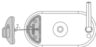
Sätt fast det nya röda locket som följer med solpanelen så att det sitter helt i nivå med baksidan av den batteridrivna kameran Pro och säkerställer vattentätheten.
