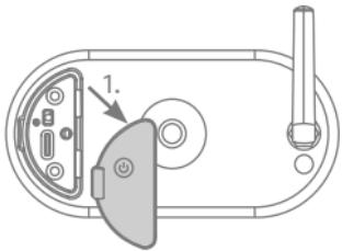
Ta av det röda locket på baksidan av din batteridrivna kamera Pro genom att dra ut gummifästet helt.
