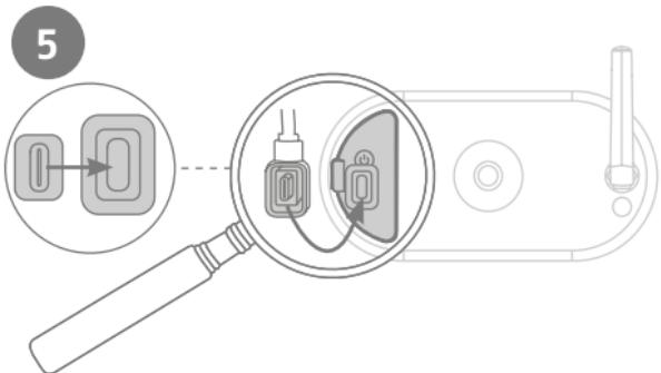
Verbinde den USB-C-Stecker des Solarpanel-Kabels mit dem USB-C-Anschluss der Akku-Kamera Pro. Achte darauf, dass der Stecker richtig und fest sitzt. Achte ebenfalls darauf, dass die Gummi-Dichtungen korrekt sitzen, damit die Wasserdichtigkeit gewährleistet ist.
