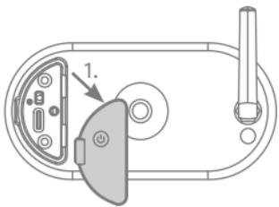
Au dos de ta caméra sans fil Pro, retire complètement le cache rouge d'origine en tirant sur l'ancrage en caoutchouc du cache rouge.
