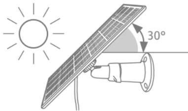
Stel het zonnepaneel precies af zodat het de hele dag door zoveel mogelijk zonlicht ontvangt. Wij raden aan het zonnepaneel te kantelen onder een hoek van ongeveer  $30^{\circ}$  ten opzichte van een denkbeeldige horizontale lijn. Draai nu het kogelgewicht vast met de vleugelschroef.
