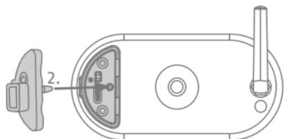
Włóż nową czerwoną pokrywę, która jest dostarczana z panelem słonecznym tak, aby nowa pokrywa była całkowicie na poziomie tylnej części kamery akumulatorowej Pro i zapewniała wodoszczelność.
