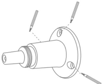
Markera var de 3 borrhålen ska sitta på önskad monteringsplats med hjälp av borrhallen eller väggfästet och t.ex. en penna. För att göra detta kan du skruva isär hållaren. När du väljer plats måste du ta hänsyn till solpanelens maximala kabellängd.
