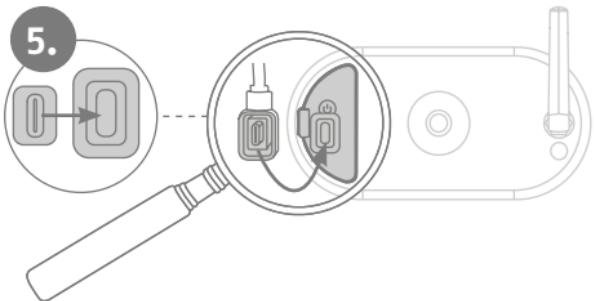
Sluit de USB-C stekker van de zonnepaneelkabel aan op de USB-C poort van de accucamera Pro. Let erop dat de stekker goed en stevig vastzit. Zorg er ook voor dat de rubberen afdichtingen correct zijn aangebracht om waterdichtheid te garanderen.
