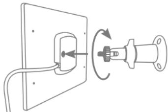
Tourne la rotule du support avec le filetage dans l'ouverture correspondante à l'arrière du panneau solaire. Serre l'écrou fourni de manière à ce que la rotule et le panneau solaire soient solidement reliés.
