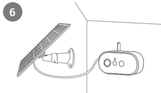
Conecta la clavija USB-C del cable del panel solar al puerto USB-C de la cámara con batería Pro. Asegúrate de que la clavija esté correcta y firmemente asentada. Asegúrate también de que las juntas de goma estén correctamente colocadas para garantizar la estanqueidad.
