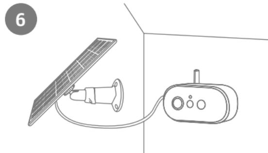
Una volta che tutti i componenti sono stati montati, controllare ancora che la nuova copertura sul lato posteriore della telecamera e la spina USB-C siano ben posizionate in modo che il collegamento sia impermeabile. A seconda della situazione di installazione in loco: per alleggerire la tensione o a seconda delle esigenze, è possibile fissare il cavo tra il pannello solare e la telecamera utilizzando le staffe per cavi.
