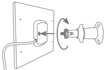
Przekręć przegub kulowy wspornika z gwintem w odpowiedni otwór z tyłu panelu słonecznego. Dokręć załączoną nakrętkę złączkową, aby przegub kulowy i panel słoneczny były stabilnie połączone.
