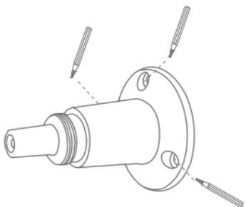
Contrassegnare la posizione dei 3 fori necessari nella posizione desiderata utilizzando la dima di foratura o il supporto a parete e, per esempio, una matita. A questo scopo, il supporto può essere svitato. Nella scelta della posizione, considerare anche la lunghezza massima del cavo del pannello solare.
