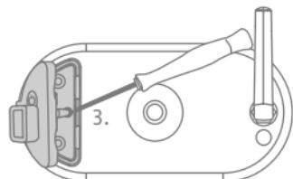
**Conseil :** Pour mettre en place le petit ancrage en caoutchouc à l'intérieur du nouveau couvercle, tu peux utiliser un objet étroit, par exemple un très petit tournevis. Assure-toi que l'ancre tient bien le nouveau couvercle rouge.
