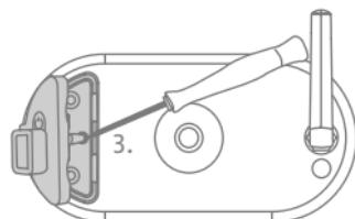
**Tips:** För att placera det lilla gummiankaret på insidan av det nya locket kan du använda ett smalt föremål, t.ex. en mycket liten skravmejsel. Se till att ankaret håller fast det nya röda locket ordentligt.
