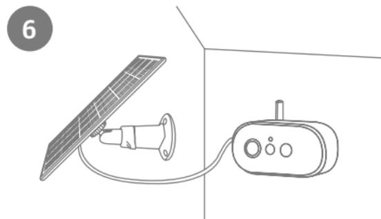
Po zakończeniu montażu wszystkich elementów sprawdź jeszcze raz, czy nowa osłona z tyłu kamery i złącze USB-C są dobrze osadzone, aby połączenie było wodoodporne. W zależności od sytuacji montażowej na miejscu: W celu redukcji naciągu kabel między panelem słonecznym a kamerą można zamocować opaskami kablownymi.
