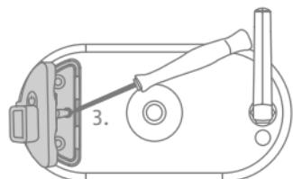
**Porada:** Aby umieścić małą gumową blokadę po wewnętrznej stronie nowej pokrywy, można użyć wąskiego przedmiotu, np. bardzo małego śrubokręta. Upewnij się, że blokada pewnie trzyma nową czerwoną osłonę.
