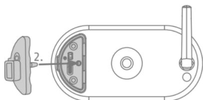
Sæt den nye røde afdækning, der følger med solpanelet, i, så den nye afdækning sidder helt i niveau med bagsiden af batterikamera Pro og sikrer vandtæthed.
