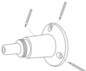
À l'aide du gabarit de perçage ou du support mural et d'un crayon par exemple, marque la position des 3 trous nécessaires à l'endroit souhaité. Pour cela, tu peux dévisser le support. Lors du choix de l'emplacement, tiens également compte de la longueur maximale du câble du panneau solaire.
