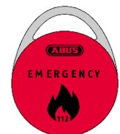
Im Notfall – das ist in der Regel der Notruf bei der Feuerwehr – schaltet die Einsatzzentrale den Zugang zum Schlüsseldepot für die Einsatzkräfte frei. Mit dem TECTIQ Notöffnungstransponder versetzen die Einsatzkräfte beim Präsentieren die jeweiligen Türen dauerhaft in den Geöffnet-Zustand. Dieser Zustand muss nach Abschluss des Einsatzes wieder zurückgesetzt werden.
