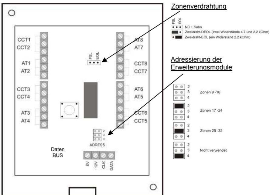
Am Daten-BUS werden, wie in der Installationsanleitung der Zentrale beschrieben, die 4 Kabel vom Kommunikationsbus der Zentrale angeschlossen. Weitere Module werden parallel an diesen BUS angeschlossen. Die Unterscheidung der Zonenbereiche wird durch die Adressierung der Module vorgenommen.
