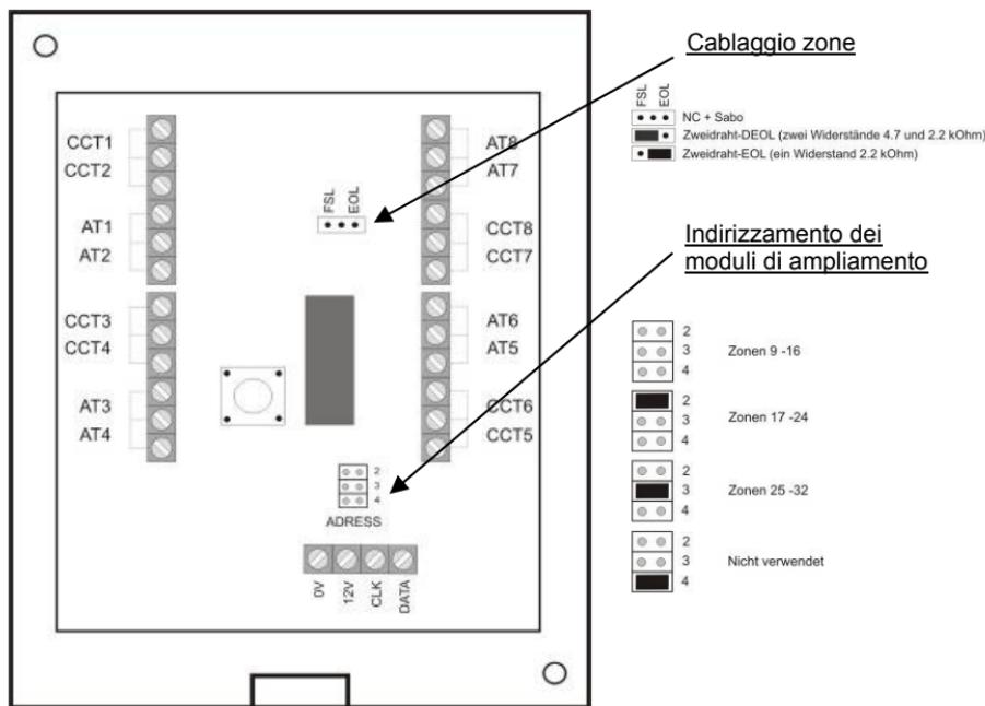
Sul BUS dati vengono collegati, come descritto nelle istruzioni per l'installazione della centralina, i cavi del bus di comunicazione della centralina. Gli altri moduli vengono collegati a questo BUS in parallelo. L'indirizzamento dei moduli consente di contraddistinguere le zone.
