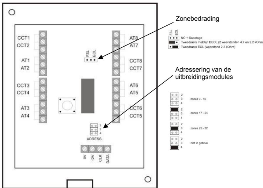
Op de data-BUS worden, zoals in de installatie-instructies van de centrale beschreven, de 4 kabels van de communicatiebus van de centrale aangesloten. Andere modules worden parallel op deze BUS aangesloten. Het onderscheid tussen de zonebereiken wordt door de adressering van de modules aangebracht.
