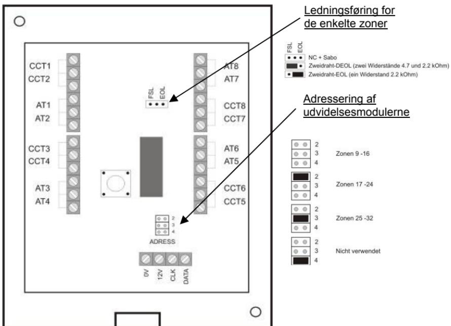
Tilslut de 4 kabler fra centralens kommunikations-BUS til data-BUS'en som beskrevet i centralens installationsvejledning.
