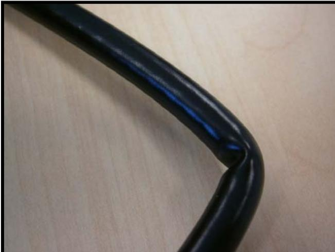
Beachten Sie den Biege-/ bzw. Knickradius (nicht <6cm) des Kabels. Bei Überknickung des Kabels dieses bitte nicht wiederverwenden, da die Videodaten fehlerhaft oder gar nicht übertragen werden könnten.
