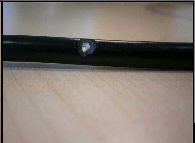
Vergewissern Sie sich, dass das Kabel keine Schäden aufweist. Bei Beschädigung des Kabels können Videosignalverluste und/oder Probleme bei der Übertragung auftreten.
