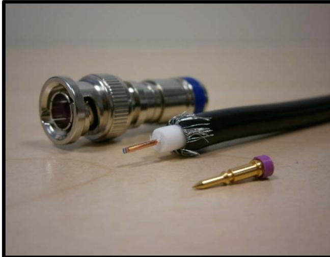
Entfernen Sie 12mm der Gummi-Isolationsschicht des RG6-Kabels. Schieben Sie das Aluminiumgeflecht in die entgegengesetzte Richtung von der offenen Seite des Kabels weg. Entfernen Sie zusätzlich die ersten 5mm des Dielektrikums, so dass der starre Innenleiter freiliegt.
