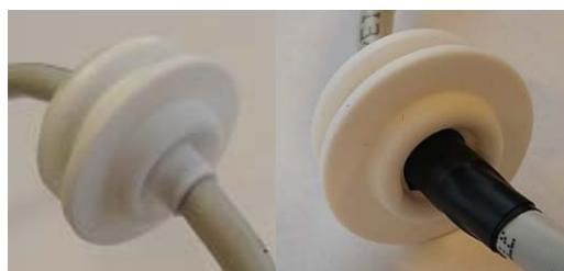
Die Gummidichtung muss am äußeren Rand ebenfalls vollständig an der Gehäusedurchführung anliegen. Falls dies aufgrund von Kabelknickungen oder anderen auf das Kabel wirkenden Kräften nicht der Fall ist, so muss der äußere Rand mit Silikon abgedichtet werden.
