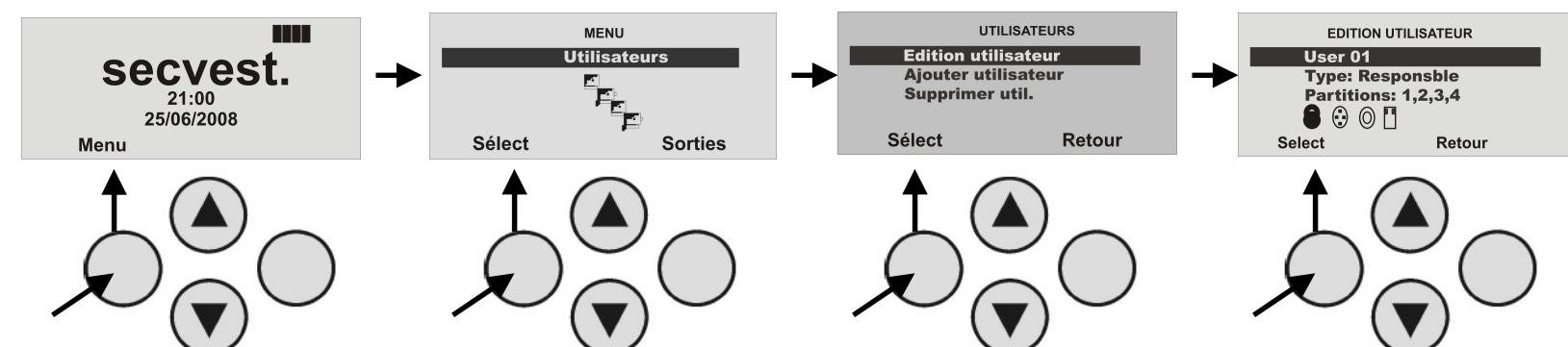
Sélectionnez, par exemple, « Télécommandes » dans le menu, pour affecter une commande à distance à l'utilisateur concerné. Ce menu permet également de procéder à l'apprentissage du cylindre sans fil SecvestKey.
