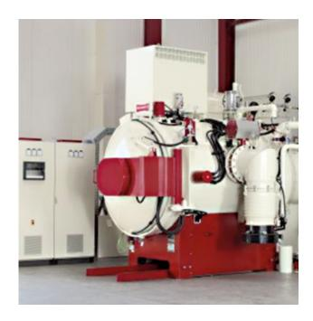
Die Schmetz GmbH in Menden gehört als Tochtergesellschaft der Metall Technologie Holding GmbH zu den globalen Marktführern für elektrisch beheizte Vakuum-Ofenanlagen mit Überdruck-Gasabschreckung. Das Unternehmen ist derzeit weltweit erster und einziger Anbieter für Anlagen mit kombinierter Wärmebehandlung im Bereich von plus 1600°C bis minus 145°C. Diese Prozesse können in den modernen Schmetz-Anlagen ohne zeitaufwändiges Umchargieren durchgeführt werden.
