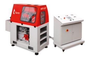
rollierenden Rohrumformmaschinen erfolgt wie bei den axialen Rohrumformmaschinen per Touch-Panel mit integriertem Datenspeicher.
