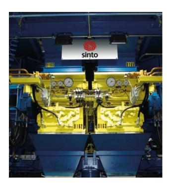
Die Heinrich Wagner Sinto Maschinenfabrik GmbH, seit 1983 Teil der japanischen Sintokogio-Gruppe, ist heute marktführender Hersteller von kastengebundenen Formanlagen für Gießereien zur Herstellung von Sandformen. Mit diesen Anlagen werden beispielsweise Bremsscheiben, Motorblöcke und Elektromotorengehäuse abgeformt und gegossen.
