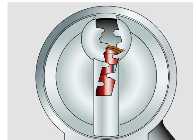
Das mehrfach parzentrische Konturprofil und die codierte Profilrippe mit Profilabfragestift schützen vor Zylinder- und Schlüsselmanipulation.
