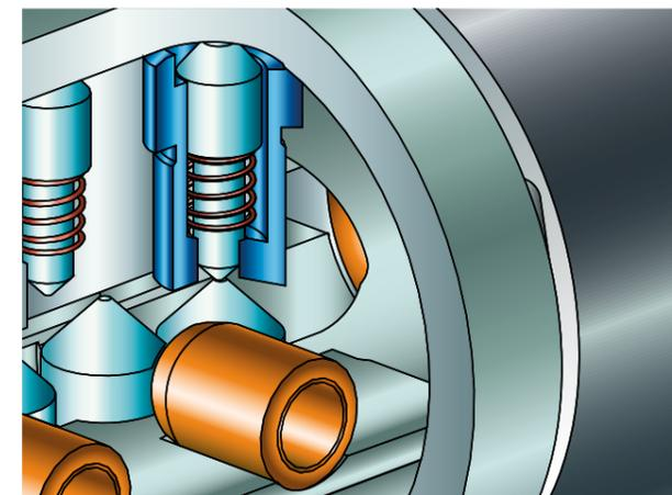
Im Zylinder erfolgt eine zusätzliche Abfrage der Schließberechtigung durch das Inspect System. Bei einem gefälschten Schlüssel blockiert die Einheit den Zylinderkern.
