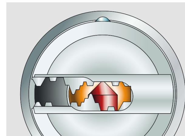
Das moderne Wendeschlüsselsystem mit horizontaler Schlüsseinführung bietet seinen Nutzern höchsten Schließkomfort. Für ein leichtes Einführen des Schlüssels sorgt das hochwertige Präzisionsprofil.
