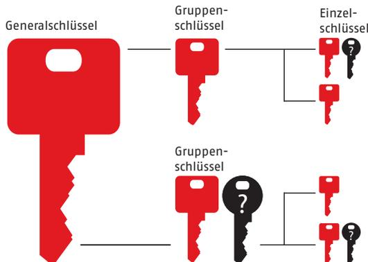
Abb. 1: Beispiele einer Schließanlage mit illegalen Schlüsselkopien
