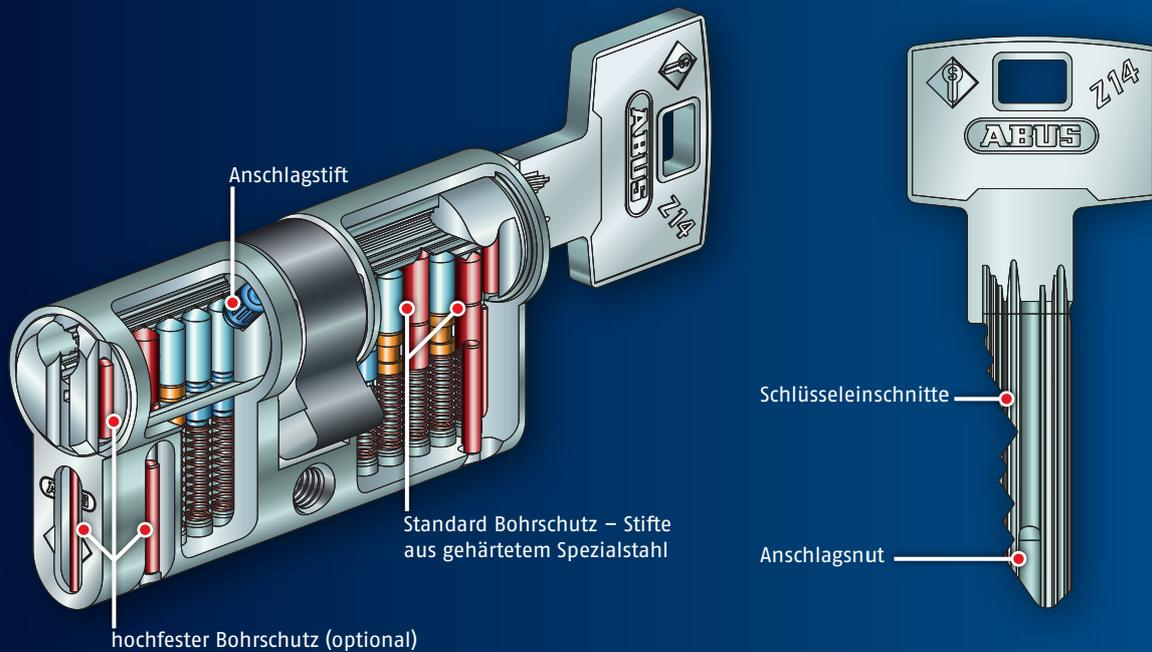
Sämtliche Zylinderabbildungen mit optionalem Bohrschutz
