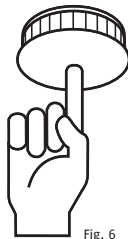
Allarme disattivare temporaneamente
