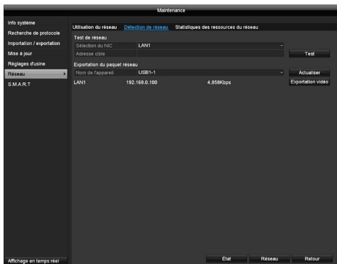
« Test de réseau » vous permet de contrôler la connexion avec un autre appareil, comme un ordinateur par exemple. Entrez l'adresse réseau de l'appareil à vérifier (p.ex. 192.168.0.25) puis cliquez sur **Test**.
