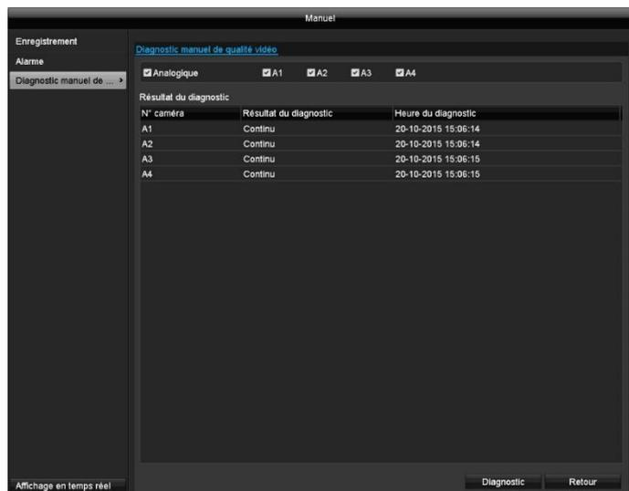
Appuyer sur le bouton « Diagnostic » pour démarrer l'analyse manuelle. Modifiez les réglages dans le menu Caméra si le résultat du diagnostic fournit un message d'erreur même lorsque le réglage de l'image est correct (image floue, voile coloré, etc.).
