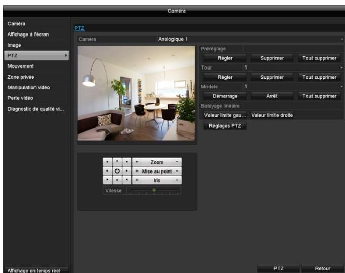
Sélectionnez le canal de caméra à éditer dans « Caméra ». En cas d'utilisation d'une caméra PTZ analogique HD, les signaux de commande sont directement transmis via le câble BNC.
