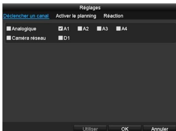
Sélectionnez un ou plusieurs canaux de caméra qui provoqueront une réaction en cas d'alarme. Cliquez sur **Utiliser** pour confirmer les réglages et sur **OK** pour quitter le menu.
