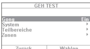
2. In questo caso si sente un tono in risposta se si attiva un rilevatore nel Walk test.
