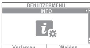
1. In primo luogo bisogna conoscere l'indirizzo IP del Secvest. Per conoscerlo, basta selezionare nel menu utente del Secvest la voce "Info": selezionare "Comunicazione" -> "Ethernet".
