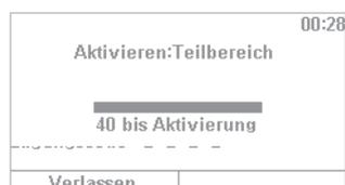
2. Dopo aver inserito il codice inizia a decorrere il cosiddetto "Tempo di ritardo" (nell'impostazione standard dell'impianto). In questo lasso di tempo bisogna uscire dall'edificio. Si calcoli, dunque, un tempo sufficiente per accedere all'esterno. Se per esempio sono già trascorsi 35 sec. e si deve ancora attraversare la porta di casa, di regola è un tempo troppo breve e un allarme può scattare, poiché anche l'apertura/la chiusura della porta d'ingresso richiede un tempo.
