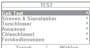
1. Con il cosiddetto "Walk test" si possono testare i rilevatori. Se ad esempio si desidera sapere se un determinato rilevatore funziona correttamente, non c'è bisogno di far scattare un allarme. È sufficiente passare al "Walk test" per testare il rilevatore in questione. Consigliamo di seguire la seguente procedura: aprire il Walk test e attivare il menu "Gong On".
