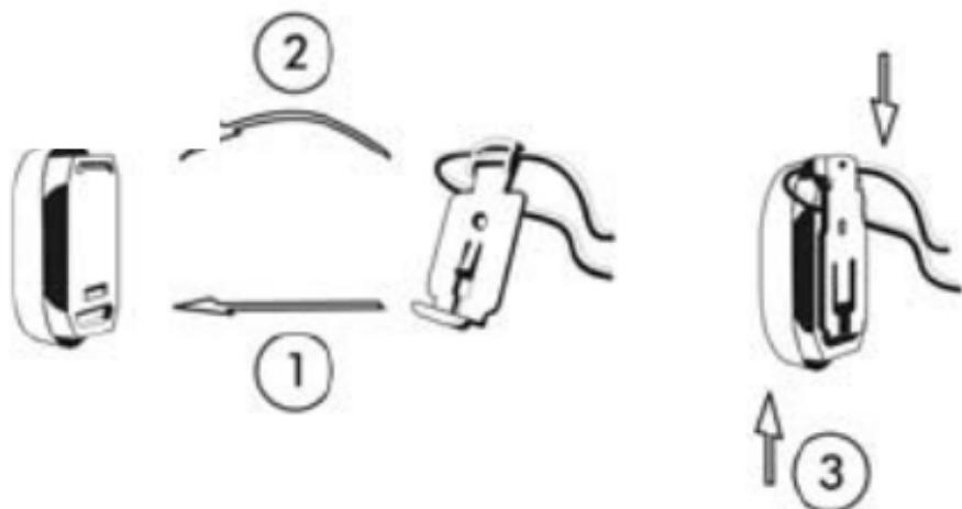
Inserire l'estremità inferiore del fermaglio da appendere nella fessura inferiore dell'alloggiamento (1).
