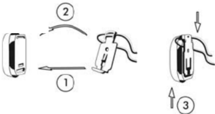
Introduisez l'extrémité inférieure du clip du collier dans la fente inférieure du boîtier (1).
