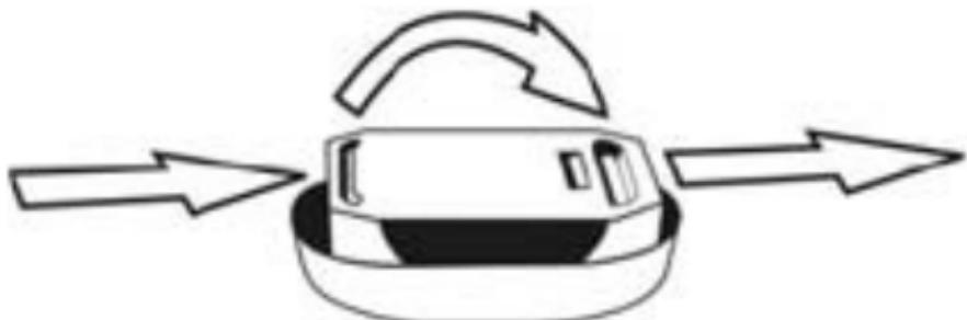
Führen Sie das elastische Armband wie abgebildet durch das Gehäuse.
