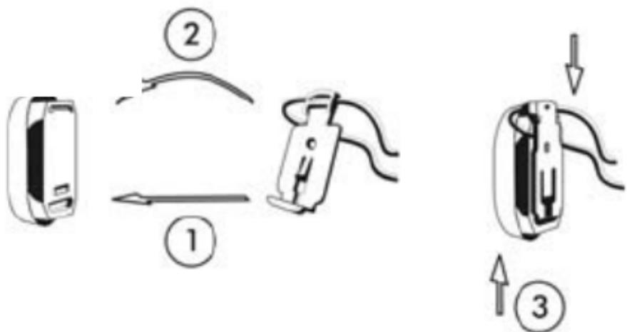
Stop het onderste einde van de omhangclip in de onderste sleuf van de behuizing (1).
