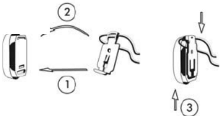
Stecken Sie das untere Ende des Umhängeclips in den unteren Schlitz des Gehäuses (1).
