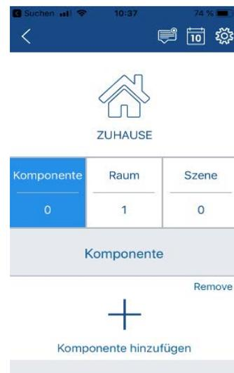
*Hinweis: Wenn das Hinzufügen fehlgeschlagen ist, prüfen Sie ob die Z-Wave Frequenz des Gerätes dieselbe ist, wie die des Gateways (EU). Es kann notwendig sein, das Gerät vor dem erneuten Inklusionsversuch erst wieder auszulernen, wählen Sie hier das „-“ Symbol in der Komponentenansicht und führen Sie den Exklusionsvorgang durch*
