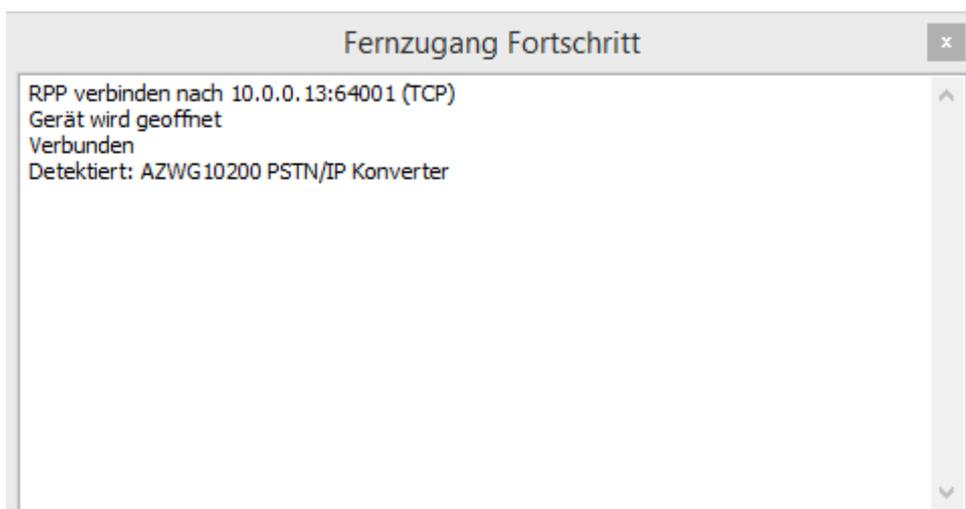
[ParamIt+](#) erkennt den AZWG10200-PSTN/IP-KONVERTER automatisch und öffnet den Startbildschirm. Die Produktinformation mit der Firmware-Version wird angezeigt. Der Status der USB- oder Fernverbindung wird mit einem grünen Symbol links unten im Bildschirm angezeigt.
