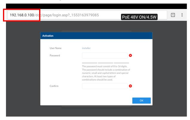
Nach der Aktivierung können Sie direkt mit der Konfiguration und Einrichtung der Kamera im Webbrowser fortfahren. Alternativ könne Sie hierfür auch die vorinstallierte IPCam Plus oder die herstellerunabhängige IPC Test App verwenden.
