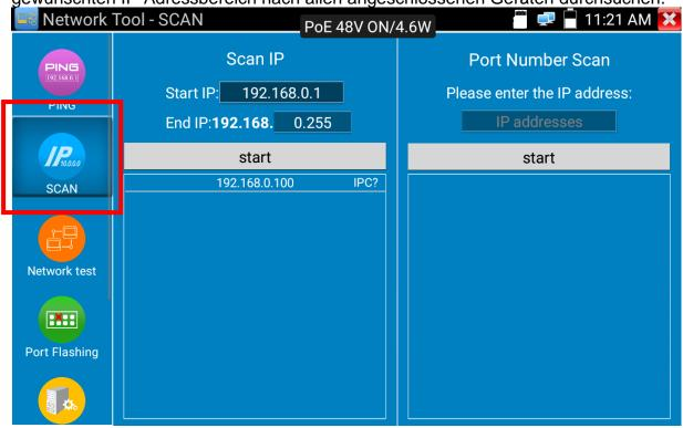
Führt diese Suche nicht zum Erfolg, da auch der Adressbereich nicht bekannt ist, könne Sie die DHCP Funktion des Testmonitors aktivieren, um dem verbundenen Gerät eine IP-Adresse aus dem benutzerdefinierten Bereich zuzuweisen.
