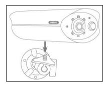
Coloque el soporte en el lugar de instalación de la cámara deseado. Marque y taladre los orificios necesarios. Utilice a continuación los tacos y los tornillos incluidos en el suministro para fijar el soporte. Seguidamente, monte la cámara sobre el soporte atornillando la rosca en el sentido de las agujas del reloj. Cuando la cámara esté completamente atornillada, bloquéela también apretando la tuerca de mariposa desde abajo.
