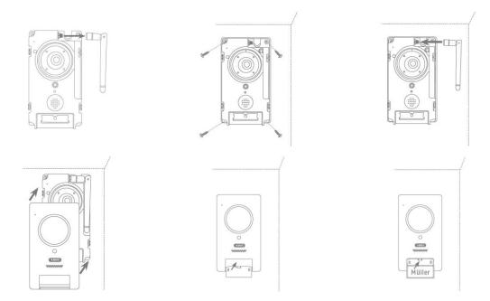
Para el montaje final, desatornille la antena al módulo para puerta y monte el módulo para puerta sobre la placa de montaje con los 4 tornillos y destornillador triangulares incluidos. Vuelva a atornillar la antena al módulo para puerta y coloque la cubierta sobre el módulo para puerta. Por último, coloque la placa de presión del timbre y la cubierta del timbre.
