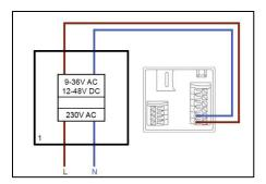
Para la alimentación de corriente a través de un cableado existente, necesita al menos 1 par de conductores disponible. Estos pueden proceder de una fuente de alimentación adicional instalada o del transformador del timbre (1). Compruebe con un amperímetro si existe la tensión suficiente y conéctelos con el bloque de conexiones V-/V+. Asegúrese de colocar correctamente los polos para la tensión continua.
