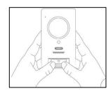
El módulo para puerta viene conectado de fábrica a la cubierta del timbre, la placa de presión del timbre y la cubierta. Para la posterior instalación, retire primero la cubierta del timbre y a continuación la placa de presión del timbre. Para retirar la cubierta, ejerza cierta presión sobre el área del timbre, abierta, y extraiga la cubierta del módulo para puerta tirando de la cubierta de abajo arriba
