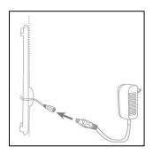
Si desea utilizar el videoportero con los materiales incluidos, conecte a la alimentación de corriente los dos cables del cable de conexión a la corriente con el bloque de conexiones. Conecte el cable rojo con DC+ y el cable negro con DC- mientras pulsa el PIN correspondiente e introduce el cable. Conecte por último la fuente de alimentación incluida con el cable de conexión a la corriente.
