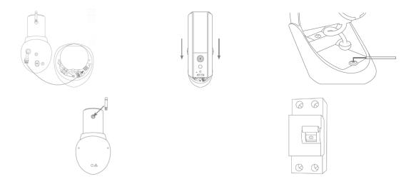
Conecte el cable de conexión de la cámara al el bloque de conexiones de la misma. A continuación, coloque la cámara en el soporte. Monte la cámara en el soporte con la llave Allen suministrada. Monte la antena en la cámara. Conecte la cámara a la corriente. La cámara está lista para la configuración cuando el LED de alimentación se ilumina permanentemente y el LED de estado parpadea 2 veces brevemente y 1 vez de forma prolongada.
