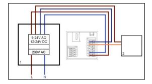
Para la conexión de un timbre o un actuador disponible a través de un cableado existente, necesita al menos 2 pares de conductores disponibles. Estos pueden proceder de una fuente de alimentación adicional instalada o del transformador del timbre (1). Compruebe con un amperímetro si existe la tensión suficiente para la alimentación de corriente.
