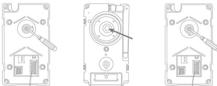
L'obiettivo dell'unità esterna può essere regolata, sul retro, al 7,5% in verticale e al 2,5% in orizzontale. Per regolare l'obiettivo, allentare la vite con il cacciavite a triangolo incluso. Prima del montaggio finale, si consiglia di collegare l'impianto di citofonia alla rete con App2Cam Plus per un orientamento perfetto. Bloccare la posizione dell'obiettivo, stringendo la vite con il cacciavite a triangolo.
