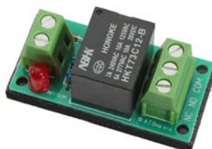
Beispiel: Fertig aufgebaute 12V Relais-Platine
