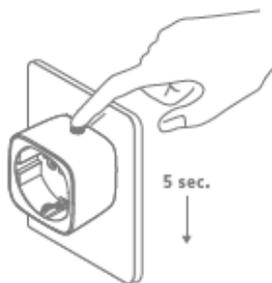
Das Gerät ist nun auf Werkseinstellungen zurückgesetzt
