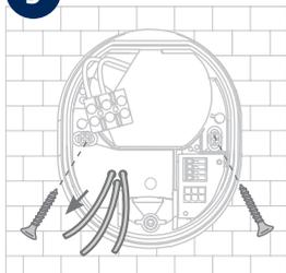
Sul retro della base della telecamera sono indicate tre piccole aperture per i tre fili del cavo di alimentazione che alimenta la telecamera con la tensione in modo regolare. Far passare i tre fili attraverso la guarnizione di gomma nei punti corrispondenti. Assicurarsi che la lunghezza del cavo sia adatta al seguente collegamento al morsetto nella base del supporto. Montare la base del supporto nella posizione prevista per la videocamera utilizzando le viti in dotazione.
