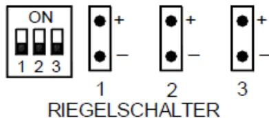
Die geschlossenen Riegelschalter sind eine Scharfschaltbedingung.
