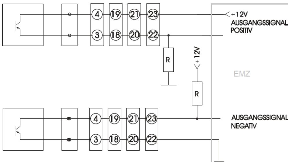
Der Widerstandswert für den zusätzlichen Widerstand R muss größer 50 Ohm sein. Wird kein Widerstand verwendet, so ist das Ausgangssignal positiv.
