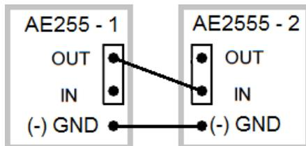
Anschluss OUT von AE255 – 1 an Anschluss IN von AE255 – 2 anschließen.
