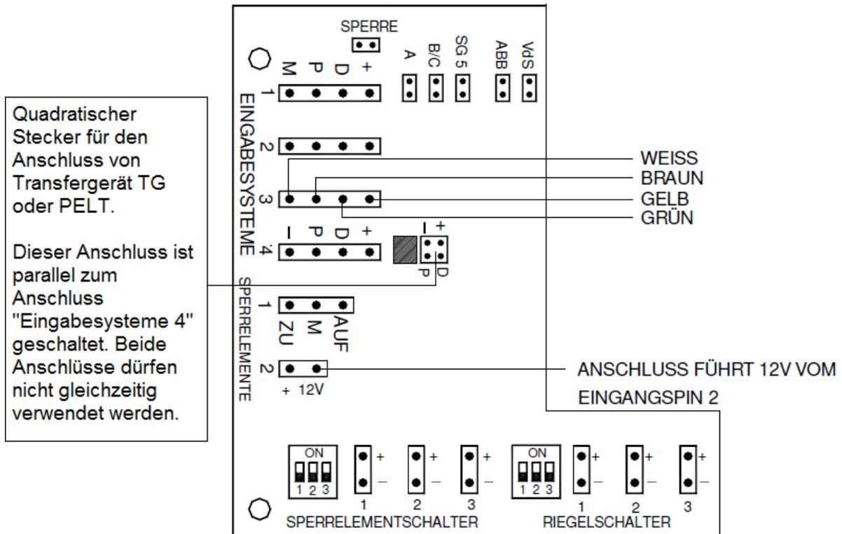
Quadratischer Stecker für den Anschluss von Transfergerät TG oder PELT.
