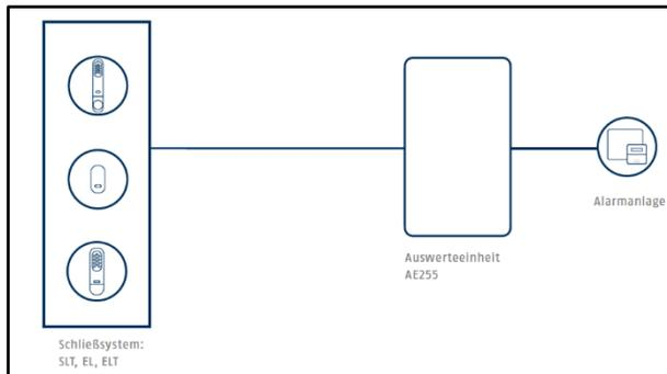
Mit der Auswerteeinheit AE255 können bis zu vier kabel- oder induktiv gebundene Türsysteme zur SCHARF- und UNSCHARF-Schaltung eingesetzt werden.
