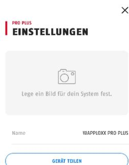
Les utilisateurs qui ont déjà ajouté le wAppLoxx Pro Control Plus à leur application peuvent le partager avec d'autres utilisateurs. Cela peut être fait dans les paramètres du Control. En cliquant sur le bouton « Partager l'appareil », l'utilisateur peut générer un code QR. Scannez le code QR avec votre smartphone. Saisissez ensuite le nom d'utilisateur et le mot de passe définis par l'administrateur. Après cela, le wAppLoxx Pro Control Plus est ajouté à votre application.
