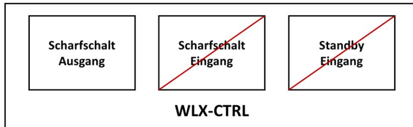
Seule la sortie d'activation du wAppLoxx Pro Control Plus est configurée, mais elle n'est pas reliée par câblage. Il est ainsi possible de bloquer les cylindres à l'aide d'une instruction d'activation jusqu'à ce qu'un instrument d'activation/désactivation valable soit présenté.
